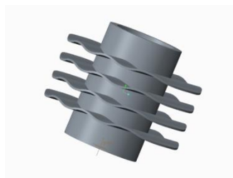
Fig. 11 Sine Fin Profile
